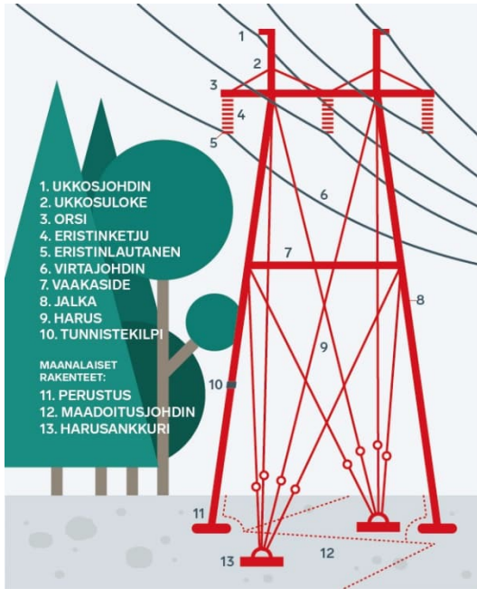
Kuva 2-6. Voimajohdon osat (Fingrid 2020).
