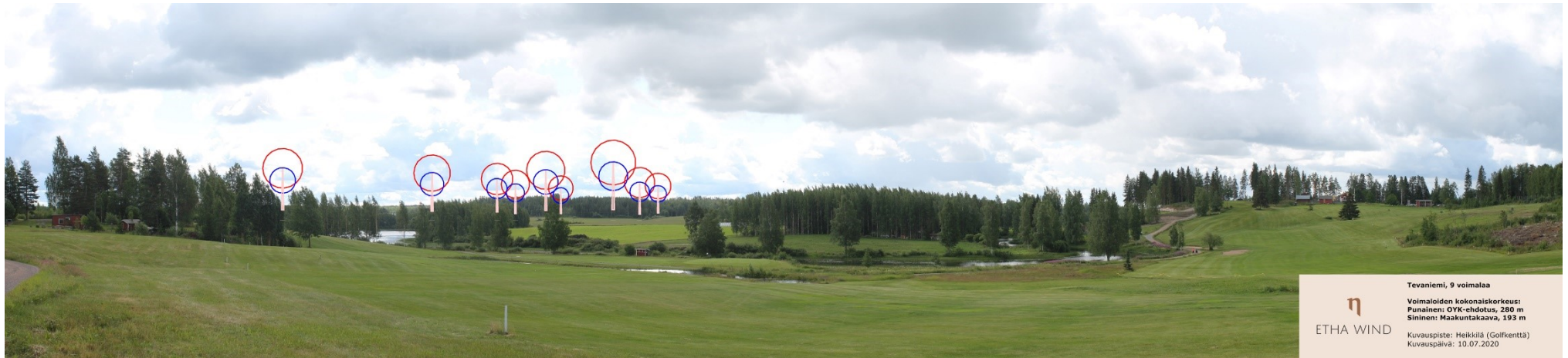
Kuva 5. Havainnekuva Heikkilästä golfkentän kohdalta. Voimaloiden sijainti on kuvattu valokuvan päälle laitettuin punaisin ympyröin. Kuvaan on merkitty sinisillä ympyröillä sen kokoiset tuulivoimalat, joita tarkasteltiin aikaisemmin maakuntakaavoituksen yhteydessä, kun tuulivoimahanke merkittiin maakuntakaavaan.
