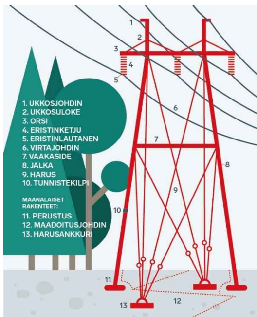
Kuva 5-7. Voimajohdon osat (Fingrid 2020).
