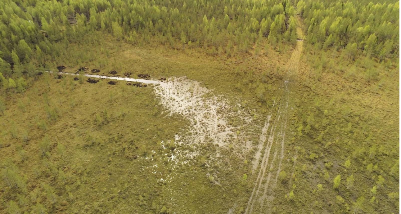
Kuva 2. Vesien suuntaaminen johto-ojan avulla suolle. Kuva Jani Antila, Tapio.
